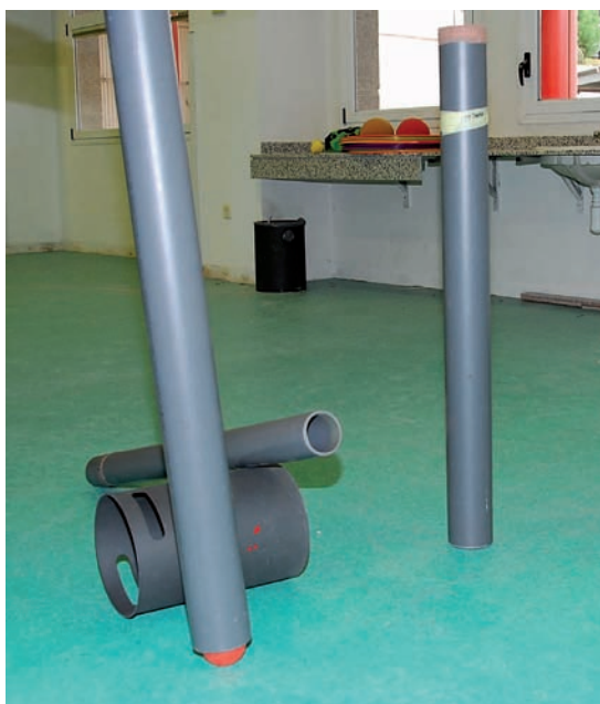
Foto 2. Tubo fabricado con PVC para recoger bolas
